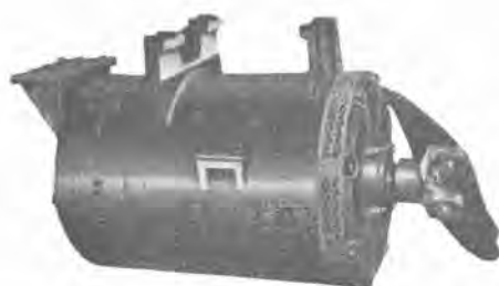
カルダン台車用 MB-3002 A 型主電動機 Type MB-3002A main traction motor for cardan truck.
