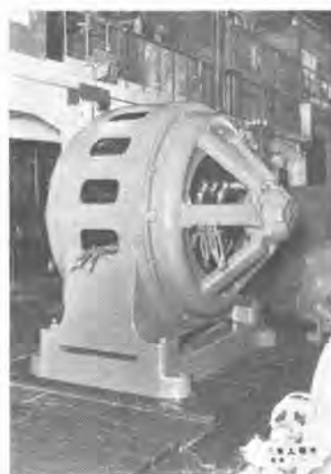
1,000 kW 3,000 V 50 へ 巻線開放型 誘導電動機 (荏原製作所納)
