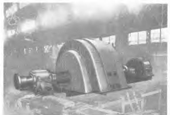
8,500 HP 450 rpm 閉鎖風道循環型誘導電動機 (八幡製鉄納) 8,500 HP 450 rpm Induction motor for steel mill.
