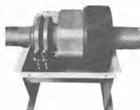
CM型電磁クラッチ Type CM magnetic clutch coupling
