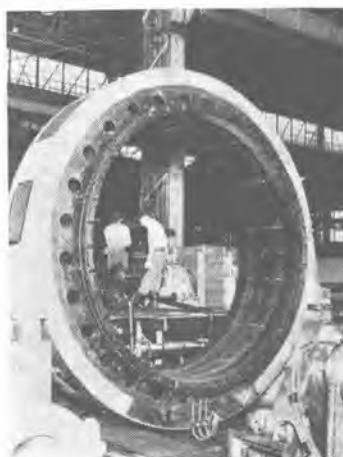
1,500 HP 257 rpm 誘導電動機 固定子（徳山鉄板納） Stator of 1,500 HP 257 rpm induction motor
