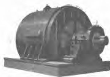
1,500 HP ミル用直流電動機（日亜製鋼納） 1,500 HP DC motor for steel mill.
