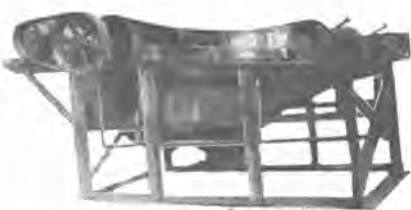
MF-36型磁石選鉱機 Type MF-36 magnetic ore separator.
