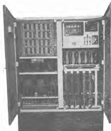
イグナイトロン整流器制御器内部 （直流電動機駆動イグナイトロン用） Controller of ignitron.
