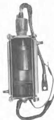
溶接器用 100 A 管 （MI-1100）の断面 Section of sealed-off ignitron for welder.
