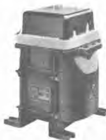
RA-15 型 15 VA 3,300/110 V 1.0 級 50~60 用共用 (耐衝撃電圧型) 計器用変圧器 Type RA-15 transformer for instrument.
