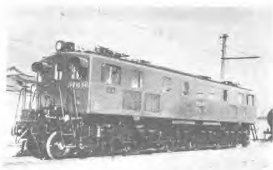
EF 15 型電気機関車 (国鉄納) 102 Ton electric locomotive.
