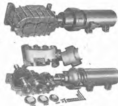
HDS-40 コンベヤ原動機 Type HDS-40 conveyer motor.
