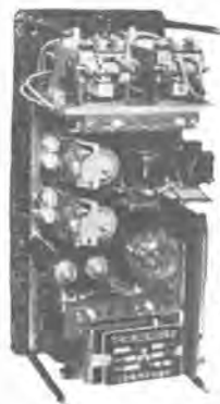
HKB 型位相比較式 搬送継電器 Type HKB phase comparison carrier current relaying device.
