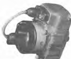
MH-2 型マグネトー Type MH magneto.
