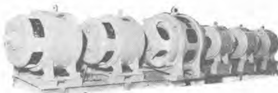
住友金属納ロートコントロール Rototrol excitor for 7,500 kW motor and 3 x 2,250 kW generators.
