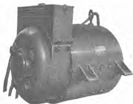
100 kW ジーゼル動車用主発電機 100 kW main generator of diesel car.
