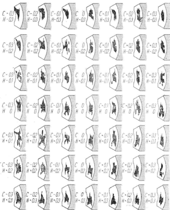
8 図 (1) 膨みをつけた場合変位による当りの変化
