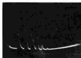
7 図 ボルト頭部の 探傷波形 (多重反射) Fig. 7. Multi refraction wave form for a bolt head.
