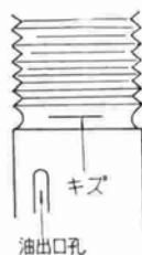
12 図 ピストンロッド磁検キズ状況 Fig.12. Mognaflux inspection for a piston rod.
