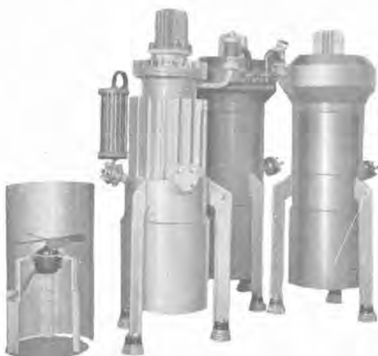
1 図 風冷式イグナイトロン整流器外観図
