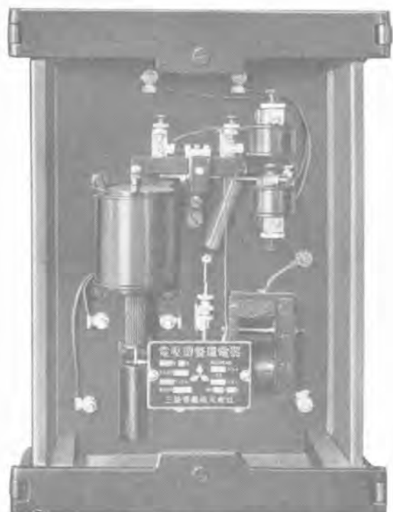
10 図 RI-E 型電圧調整継電器
