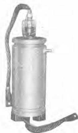
密封型金属管イグナイトロン MI の外観と断面図
