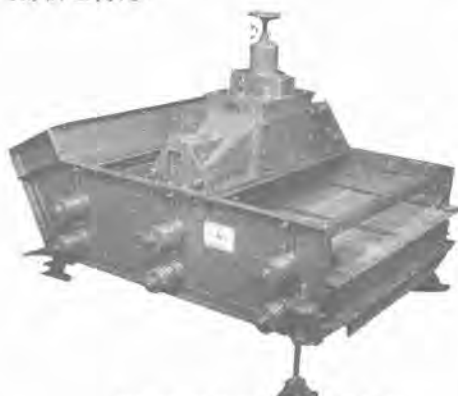
VS-12 型ハンマースクリーン (字部ソーダ納)
