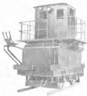
大阪ガス納 10トン電気機関車 (消化用牽引車)
