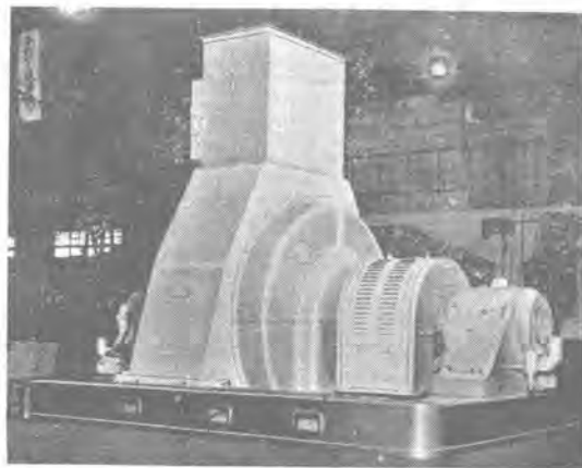
イルグナ圧延機用 5,000HP 3,150V 514rpm 誘導電動機 (富士製鉄釜石製鉄所納)
