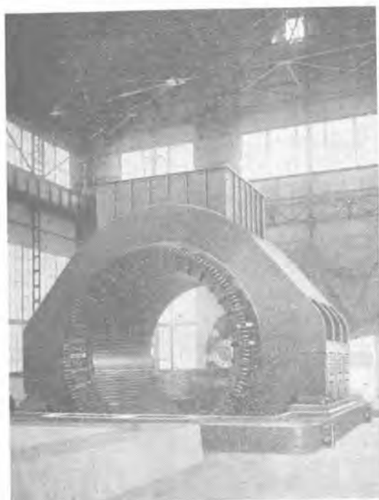
50,000kVA 短絡試験用同期発電機 固定子および緩衝装置
