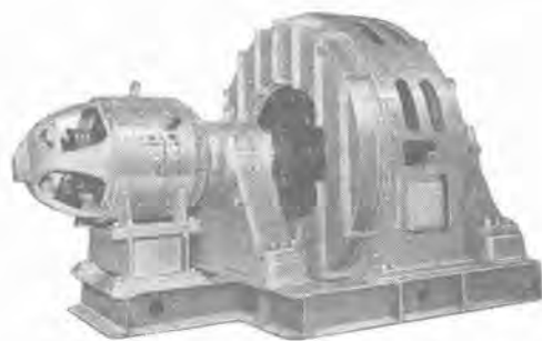
NHK 納 500kVA 514 rpm ジーゼル発電機
