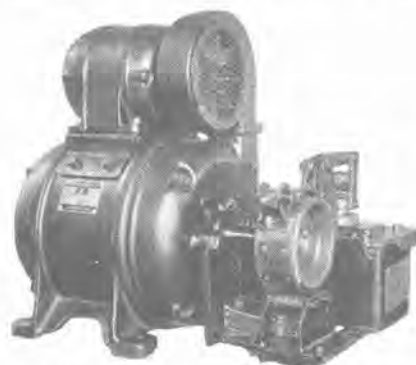
MK 他力通風型心線巻取機用電動機 起動トルク 0.8kg-m 4極 220 V60Hz
