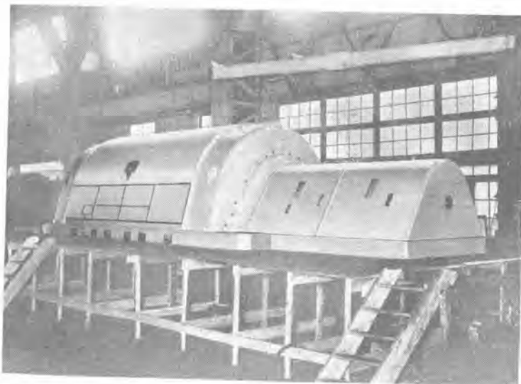
43,750 kVA 3,600 rpm タービン発電機 (九州電力築上発電所納)
