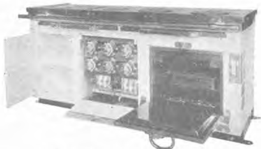
10.2kW 食堂車用電気レンジ
