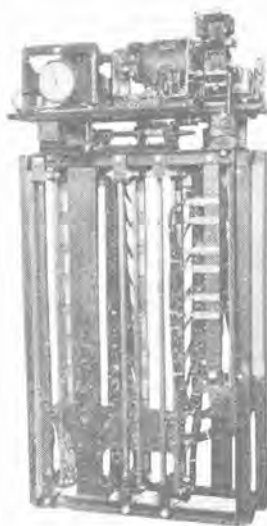
UR型負荷時タップ切換器 11 kV 100 A 17段切換
