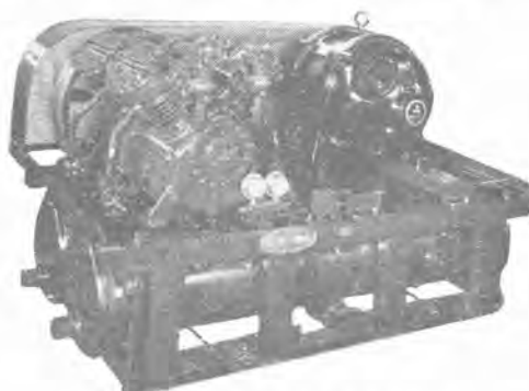
W型水冷式コンデンシングユニット
