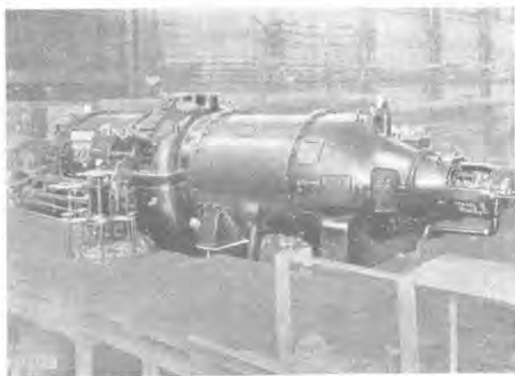
タイ国納 7,000kVA ユングストローム発電機
