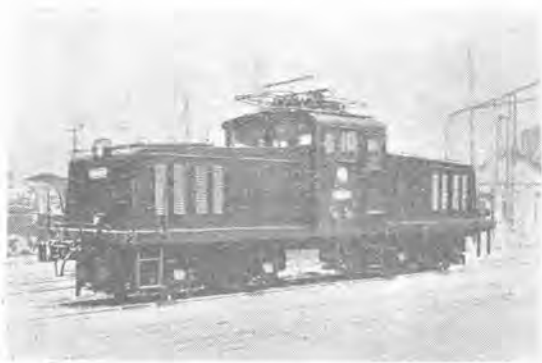
土佐電鉄納 30トン電気機関車
