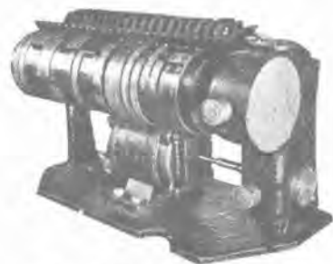
SS 101型電動機操作順序開閉器 (小田急納)
