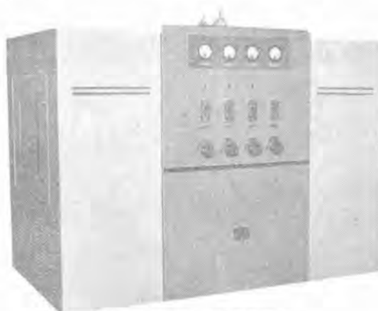
DH-3型 20kW ラジオヒータ
