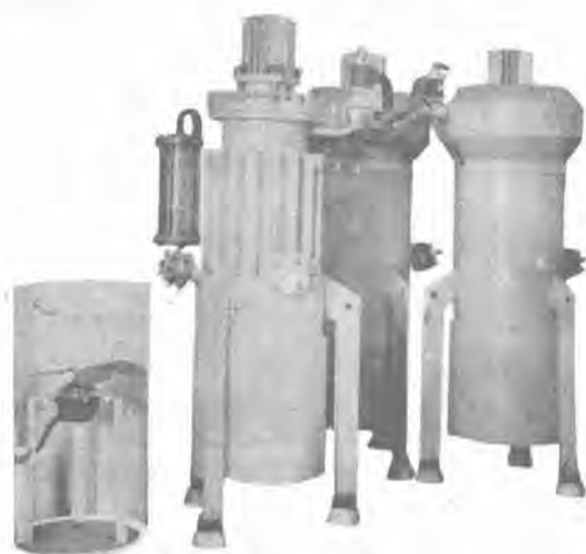
1,000kW 1.5kV 重負荷公称定格 風冷式イグナイトロン整流器
