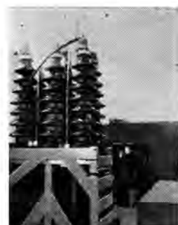
大井川発電所にて予備套管測定中
