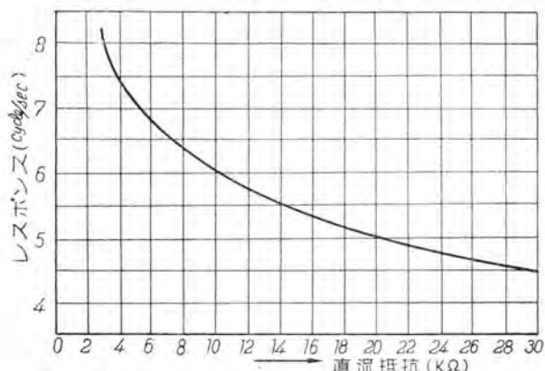
9 図 磁気増幅器のレスポンスと制御回路抵抗との関係
