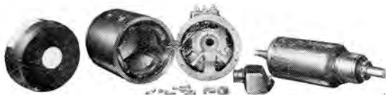
3 図 DF 300/24型 300W 充電発電機の内部構造
