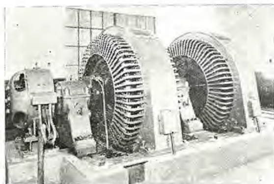
3 図 旭硝子牧山納入 1,000kW 周波数変換機 1,250kVA 3 相交流同期発電機 3,300V 50~3 φ 10P 600rpm 1,500HP 3 相交流同期電動機 3,300V 60 ~ φ 12P 600rpm 30kW励磁機 DC110V 273A 600 pm 6P
