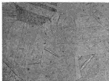
寫眞 9. 2.2%Beを800°C 30分加熱後水中焼入 (100倍)
