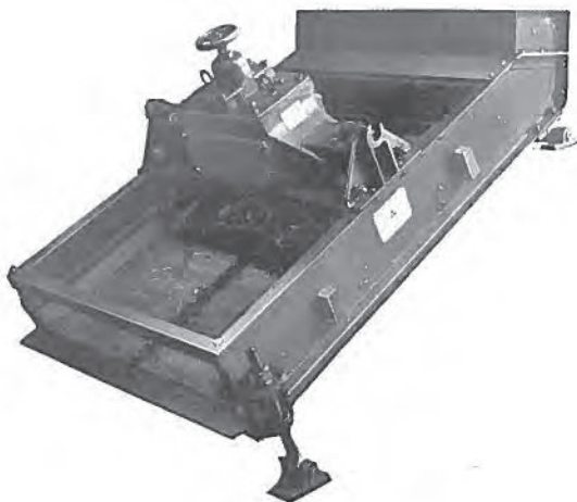
第 2 圖 VS-11 型 ハンマースクリーン 開放型（給鑛口附）
