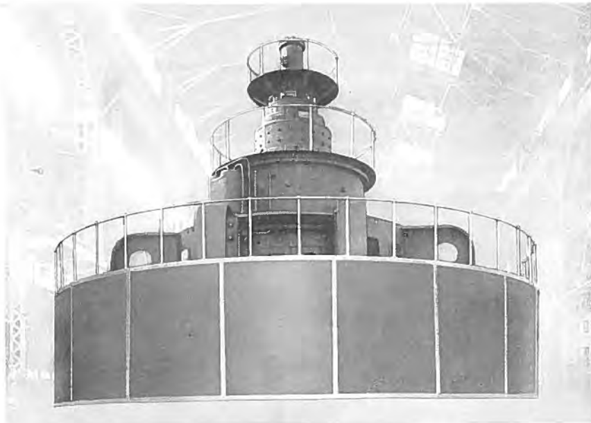
東信電気株式会社 新郷発電所 14,000 kVA 187.5 r.p.m. カプラン水車発電機 14,000 kVA 187.5 r.p.m. Kaplan Generator for Shingo Power Station, Toshin Denki K.K.
