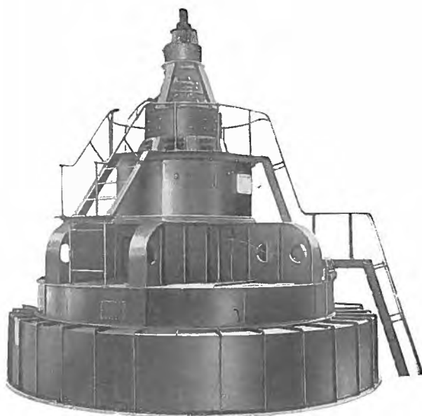
14,500 kVA 11,000 V フランシス水車発電機
