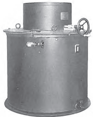
第 59 圖 500 馬力誘導電動機用液体抵抗器
