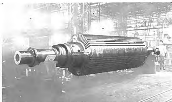
第4圖 スロットを切つた組立式回轉子
