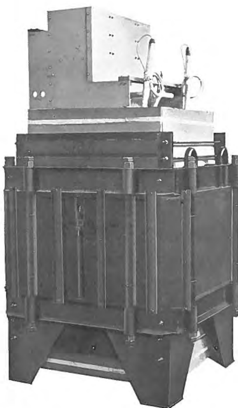
第4圖 10,000 kVA 單相三捲變壓器中身
