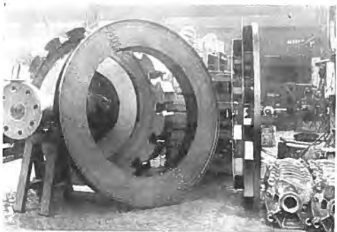
右下圖はスラスト・ベアリング用のボットであつて、此内部にスラスト・ベアリングの主体及冷却管を納め、其内に潤滑油の油層を形成して居る。鑄物であつて此の上部に勵磁機を取付ける。
