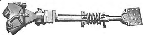
第 6 圖 K-1-A型 密着連結器平面圖
