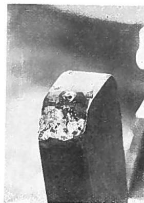
第 15 圖 油入遮断器下部接觸部 デアイオン・グリッド附
