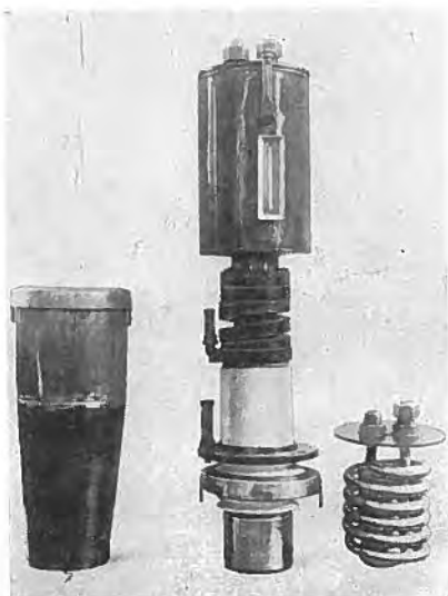
第 4 圖 三菱水銀弧光整流機の陽極
