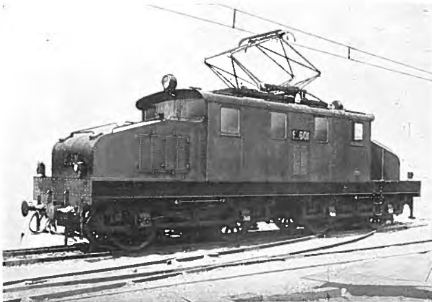
第 2 圖 製鐵所納 60 吨電気機関車
