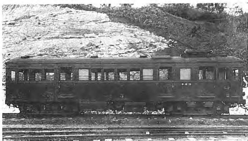
70 人乗手荷物室附電動客車、車体全長 50 呎、幅 8 呎半、高さ 12 呎 外部は小豆色に塗られて居る。自重 35 吨半鋼製
