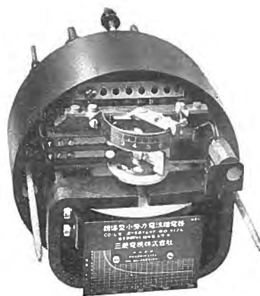
第 13 圖 CO-L 型差動継電器 (87) 閉路すれば調整機油壓唧筒用電動機 (911M) 及び軸承油循環唧筒用電動機
