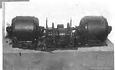
第 3 圖 同期速度檢出裝置の外形及び内部
