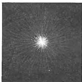
第 3 圖 A 波頭最も急峻なる正極電圖
