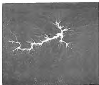
第 7 圖 測定範圍を超過せ る場合の正極電圖
