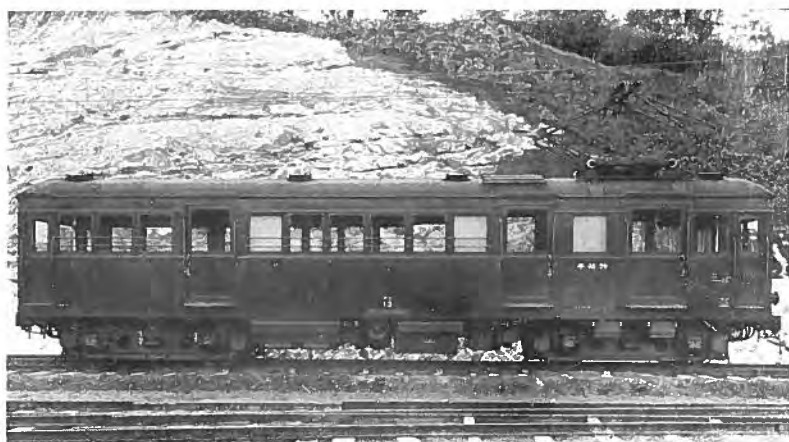
70 人乗手荷物室付電動客車、車体全長 50 呎、幅 8 呎半、高さ 12 呎、外部は小豆色に塗られて居る。自重 35 吨、半鋼製
