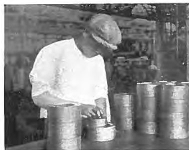
第 13 圖 固定子鐵心の内徑檢査
