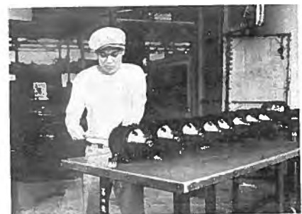
第 15 圖 兩メタル内徑ミ中心の檢査
