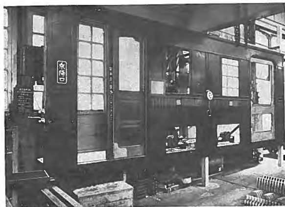
弊社神戸製作所に於てはドアエンジン将此の寫眞に示す様な設備に取付けて壽命、働き工合等詳細に試験した後納入先へ發送することゝして居ります同時に製作所見学の方々へのドア装置の説明用セットともなります
