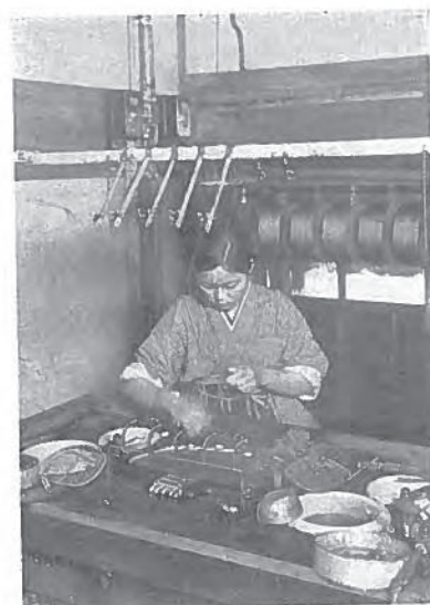
第 三 圖 某製線工場に於て三菱電気線絲鍋を使用して作業して居る所
