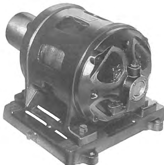
第三圖 密封ベアリングを有する三菱型モートル
