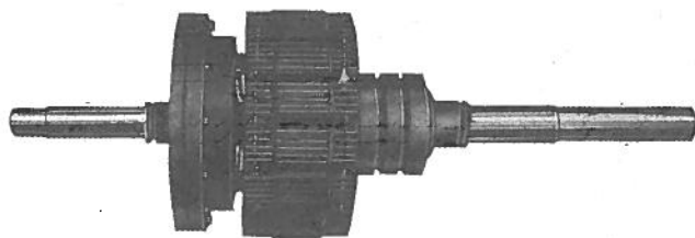
第二圖 クラッチ型同期電動機回轉子
