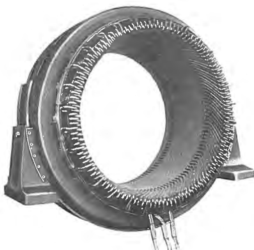
第九圖 3,750 KVA 発電機に直結せる 4,250 HP 11,000 V 電動機の固定子
