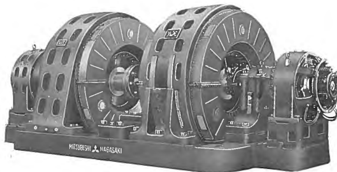
第 二 圖 3,333 KVA 周波数変換機 (50-60 サイクル)
